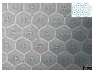
**Weit reichende Kapillarkräfte** werden zum selbstorganisierten Aufbau von dreidimensionalen Mikromustern auf Filmen aus Kohlenstoffnanoröhren (CNTs) genutzt (siehe Bild). Die Methode beruht auf der Spreitung eines Wassertropfens nach dem Erzeugen des CNT-Films. Entscheidend für die Musterbildung ist die Steuerung der Dichte des Films.
